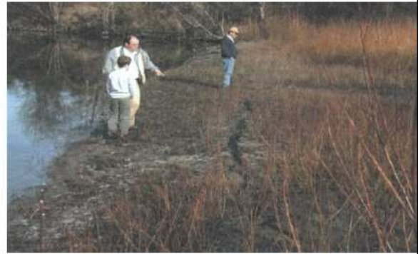
2001 Nisqually depremi Green River boyunca oluşan yanal yayılma
