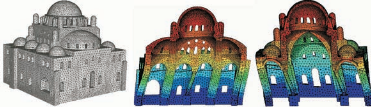
Şekil 1. Beyazıt Camii 3 boyutlu modeli (solda) ile birinci (ortada) ve ikinci (sağda) modlara ait kesit görüntüleri
