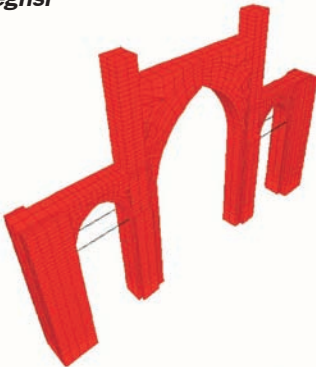
Şekil 5. Beyazıt Camii'nde doğrusal olmayan analizi yapılan çerçeve
