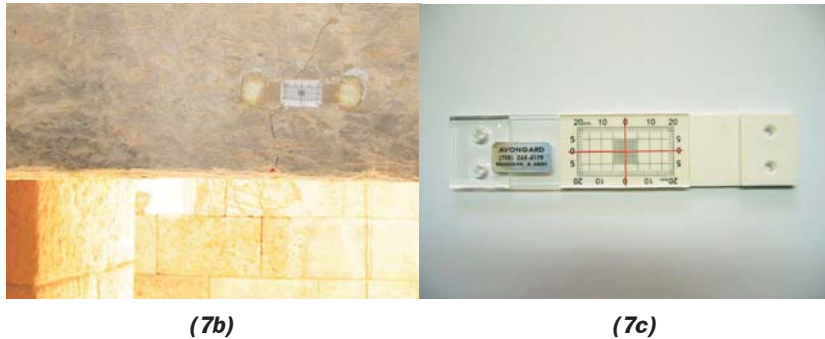
Şekil 7. (a) Çatlak Genişliği Değişimi (b) Kapı Üstü Lentosunda Çatlak Genişliği Ölçümü (Efes Tiyatrosu) (c) Çatlak Genişliği Ölçüm Cetveli
