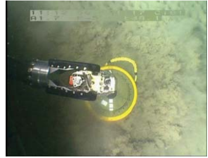
Resim-4: Marmara tabanına Okyanus Tabanı Sismografinin (OBS) yerleştirilmesi
