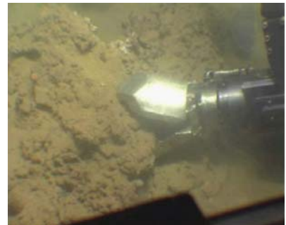
Resim-5: Marmara Denizi tabanından çökelti örneği alınması
