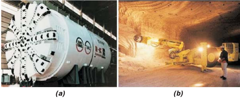
Şekil 16. Tam kesitte tünel açma aygıtından ve kollu tünel açma makinesinden bir görünüm
